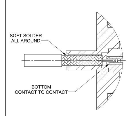
**INSULATOR SPACER BOTTOM ONTO OUTER BRAID-**
