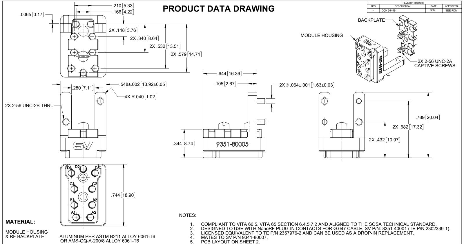
ALUMINUM PER ASTM B211 ALLOY 6061-T6 OR AMS-QQ-A-200/8 ALLOY 6061-T6
